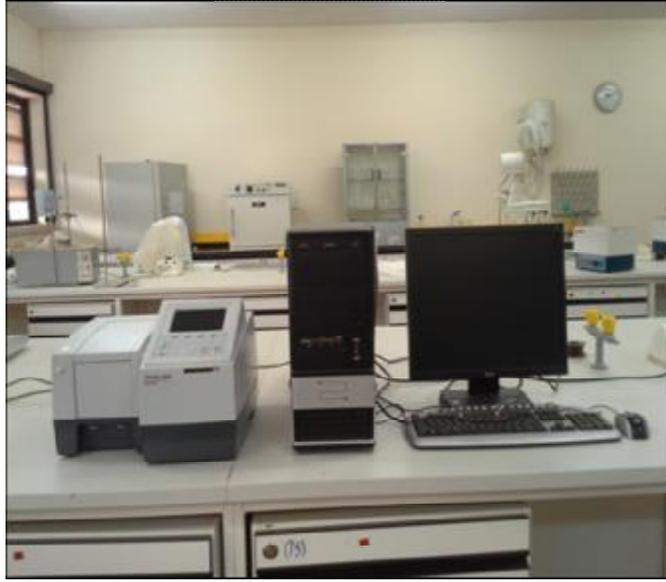
الشكل (7.4) مطياف الأشعة فوق البنفسجية المرئية UV/VIS spectrophotometer
