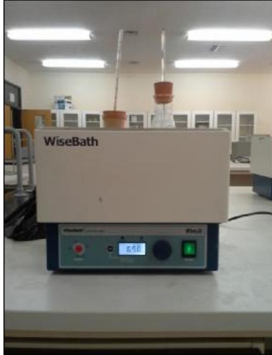
الشكل (5.4) حمام المائي المستخدم في عملية الحفر الكيميائي
