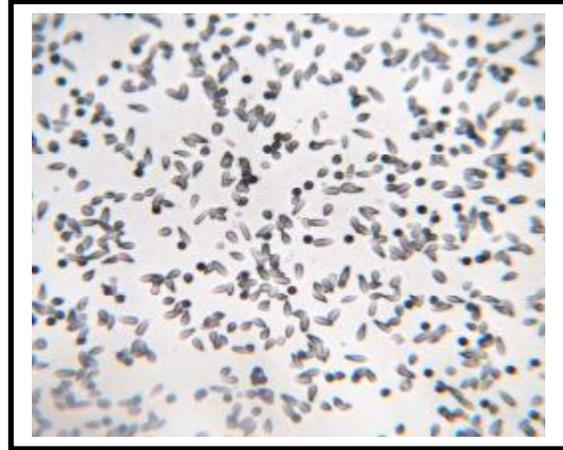
الشكل (11.5) صور فوتوغرافية للأثار النووية (جسيمات ألفا) من عنصر الأمريسيوم  $^{241}\text{Am}$  والمسجلة علي الكاشف البلاستيكي CR-39 المعالجة حرارياً عند  $120^{\circ}\text{C}$  قبل التشعيع عند زمن وفترات زمن تعرض جسيمات ألفا مختلفة من 1sec إلي 25sec و 8h
