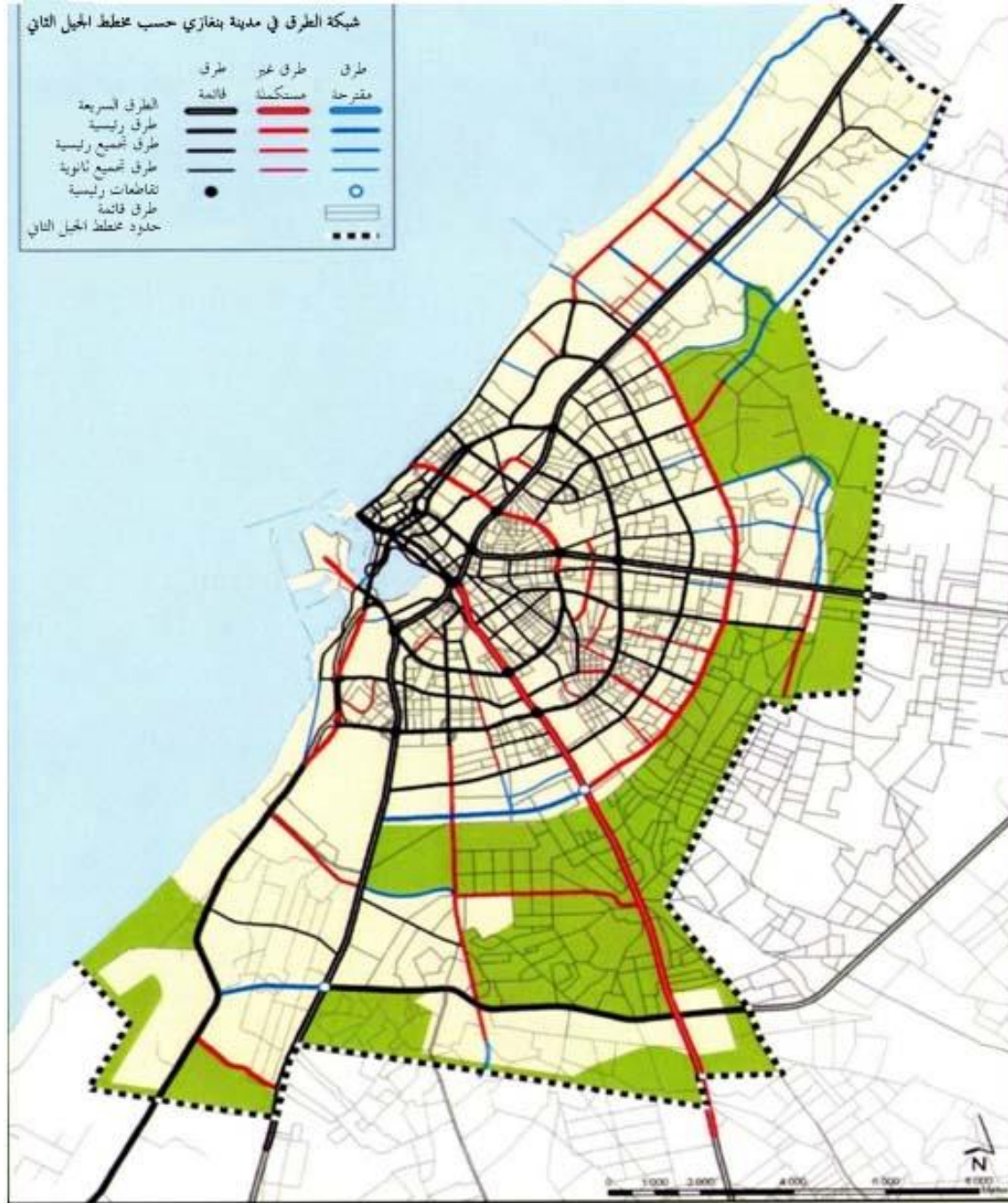
الشكل رقم (52) - شبكة الطرق بمدينة بنغازي، مخطط يبين الطرق غير المستكملة، والطرق المخططة وغير المنفذة، والطرق القائمة ودرجاتها.
