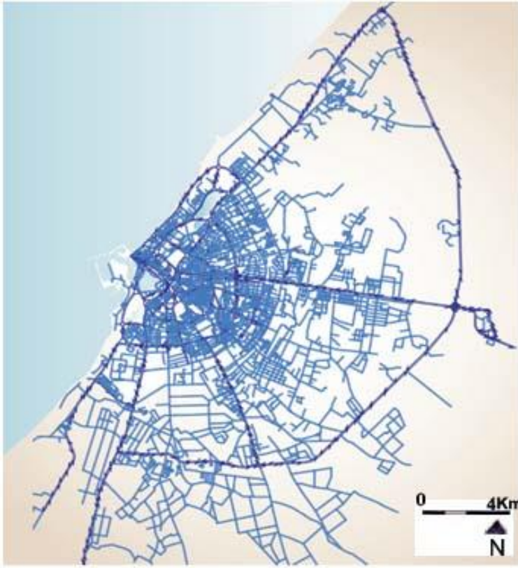
الشكل رقم (58) كثافة شبكة الطرق بالمدينة ، وتباعد الطرق الشعاعية الرئيسية . المصدر: شركة سيسيتيمكا الإيطالية 2008م
