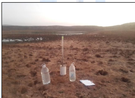
صورة (5) قياس الرشح عند نقطة 1
