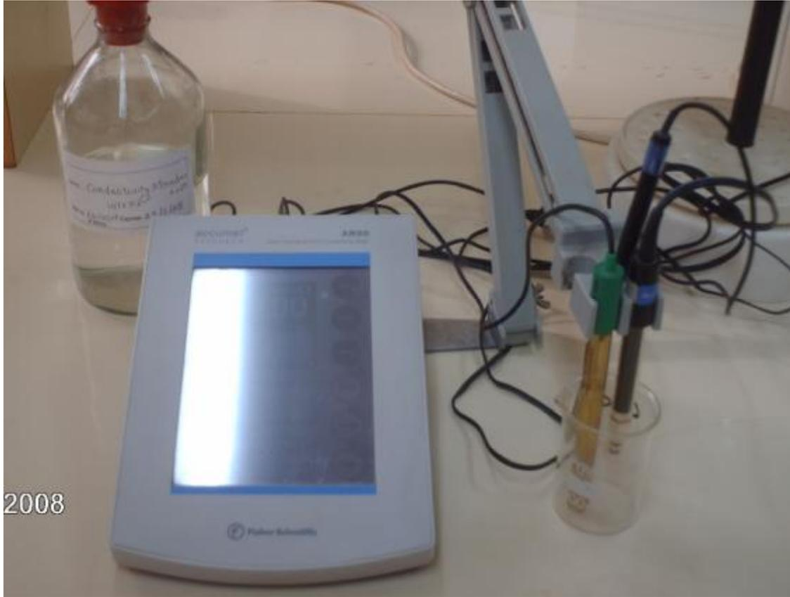
صورة (4) جهاز ( Beckman ) لقياس الرقم الهيدروجيني لمحلول التربة
