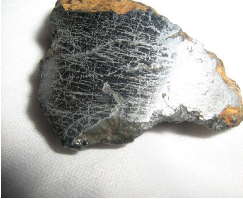
شكل (1b.5) ملامح الشكل الداخلي لعينة النيوزك بعد سنفرة الوجه الخارجي.
