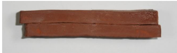
شكل (36) يوضح تقوس وتزجج والتصاق نموذج (N) في درجة حرارة °م1100
