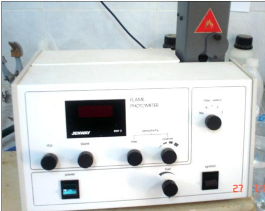
جهاز مطياف اللهب Flame Photometer لقياس الصوديوم
