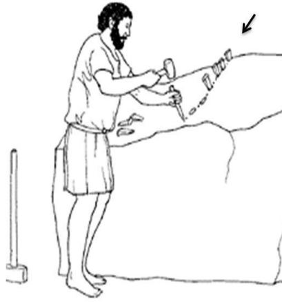
عمل خطوط أولية وتحديدها باستخدام الأوتاد
